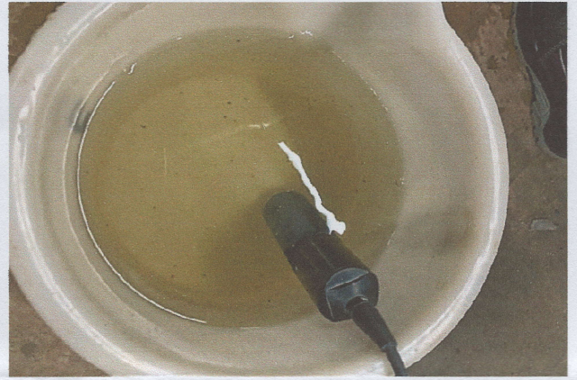
จุดเก็บตัวอย่างน้ำทิ้ง จุดที่ ๑ บ่อพักน้ำทิ้งของระบบบำบัดน้ำเสียที่จะระบายลงสู่รางระบายน้ำรอบอาคาร
