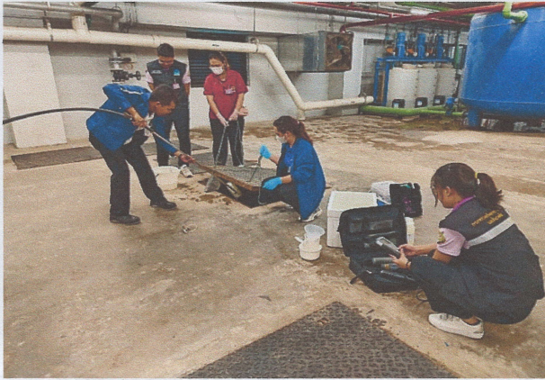
จุดเก็บตัวอย่างน้ำทิ้ง จุดที่ ๑ บ่อพักน้ำทิ้งของระบบบำบัดน้ำเสียที่จะระบายลงสู่รางระบายน้ำรอบอาคาร
