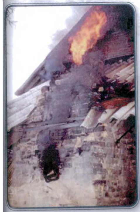
รูปที่ ๖-๙ ไฟแรงขึ้นจึงเปิดช่องที่อยู่ ชั้นบน (บันทึกภาพ พ.ศ. ๒๕๒๓)
