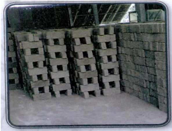
รูปที่ ๖-๓ อิฐขนาดใหญ่สำหรับก่อเตาเผา
