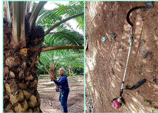
เครื่องเกี่ยวทลายปาล์ม และทางใบปาล์ม ดัดแปลงจากเครื่องตัดหญ้า
