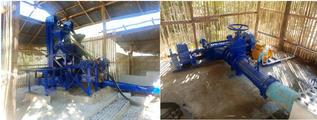
ภาพที่ ข.๒ เครื่องสูบน้ำพลังงานน้ำและเครื่องผลิตกระแสไฟฟ้าพลังงานน้ำ
